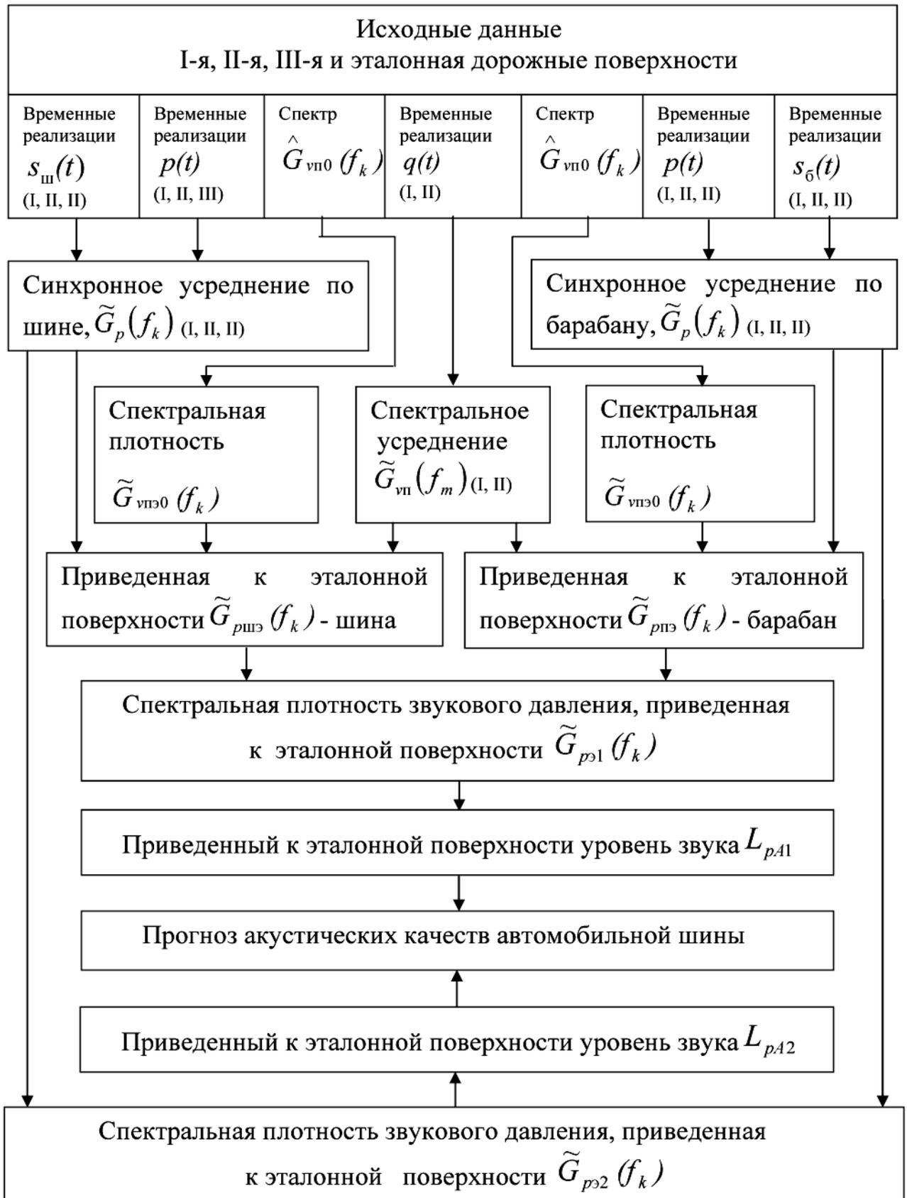
Рис. 1. Алгоритм определения уровней шума шины при скорости  $v_r$  качения автомобильного колеса
