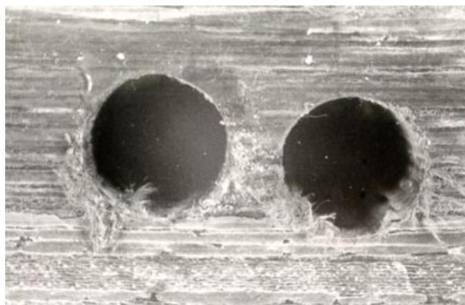
**Рис. 16. Вид отверстий на входе инструмента при сверлении слоистого ГКМ (стеклопластик-органопластик)**
