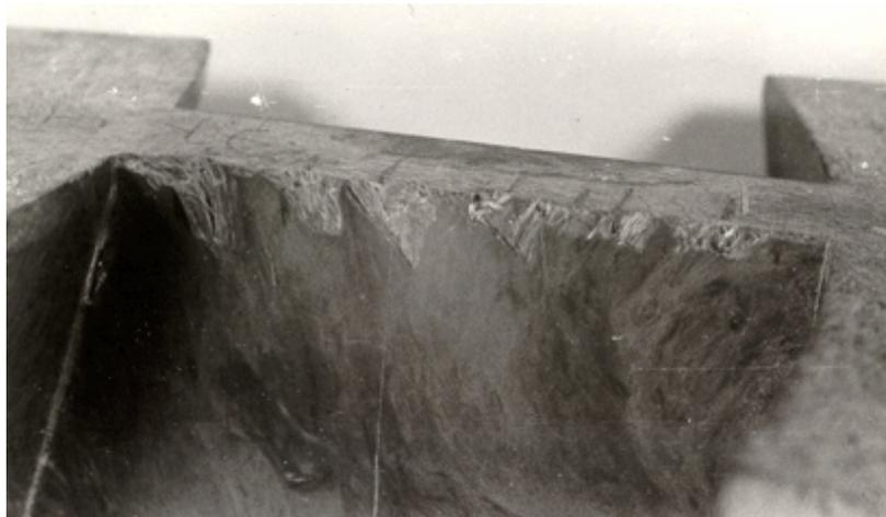
**Рис. 17. Вид сколов, образующихся при точении торцевой поверхности изделия "диск" из стеклопластика с короткими армирующими волокнами**
