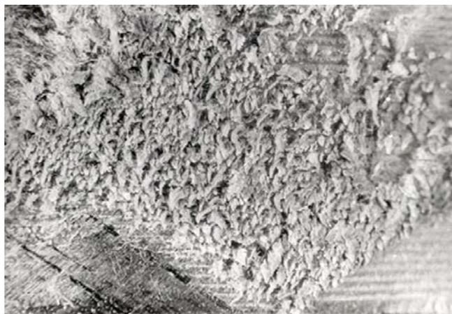
**Рис. 9. Вид поверхности изделия из органопластика после токарной обработки**
