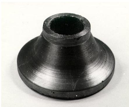
**Рис. 3. Деталь "тарель", обработанная резанием после пропитки и нанесения покрытия**
