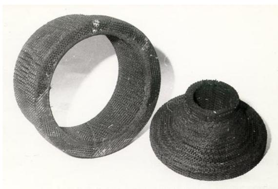
**Рис.2. Общий вид изделий типа "кольцо" и "тарель" после обработки заготовки из УУКМ резанием с "заморозкой"**
