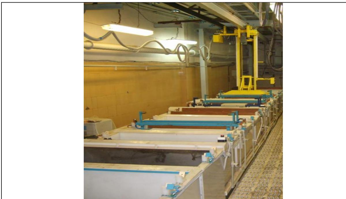
Рис. 5. Гальванические ванны.
