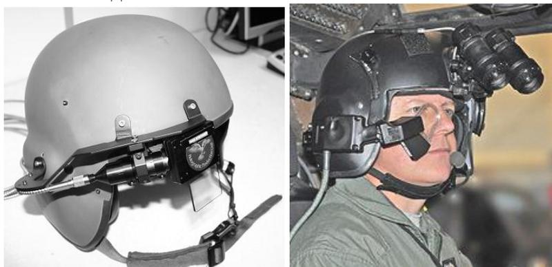
Рисунок 5. Первый прототип НСИ с ДОЭ и современный Q-sight.
