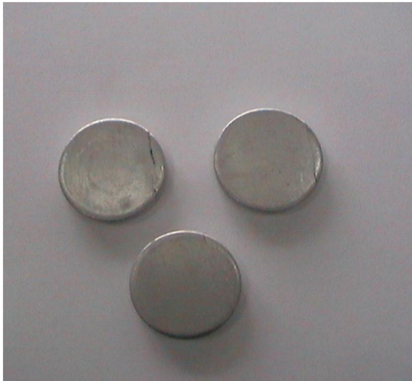
Рис. 6. Фотография заготовки с поверхностными трещинами
