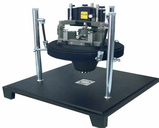
Рис. 1 – СЗМ «Solver» P47-PRO [[www.ntmdt.com](http://www.ntmdt.com)]
