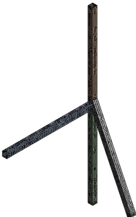
Рис. 11. Сетка конечных элементов
