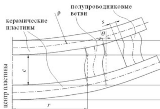
Рис. 2. Схема деформации ветвей за счет изгиба пластин:  $\rho$  – радиус кривизны пластины,  $s$  – величина взаимного сдвига полупроводниковых ветвей,  $r$  – расстояние от центра пластины,  $c$  – расстояние между пластинами
