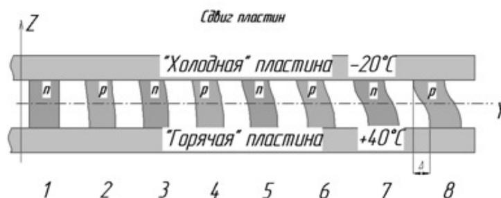
Рис. 3. Схема деформации ветвей ТМ за счёт температурных деформаций керамических пластин:  $\Delta$  – сдвиг полупроводниковой ветви
