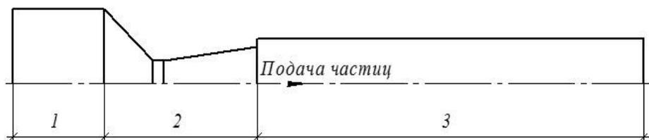
Рис. 1. Схема технологической установки для сверхзвукового газопламенного напыления покрытий: 1 - камера сгорания; 2 - сопло; 3 - сопловой насадок
