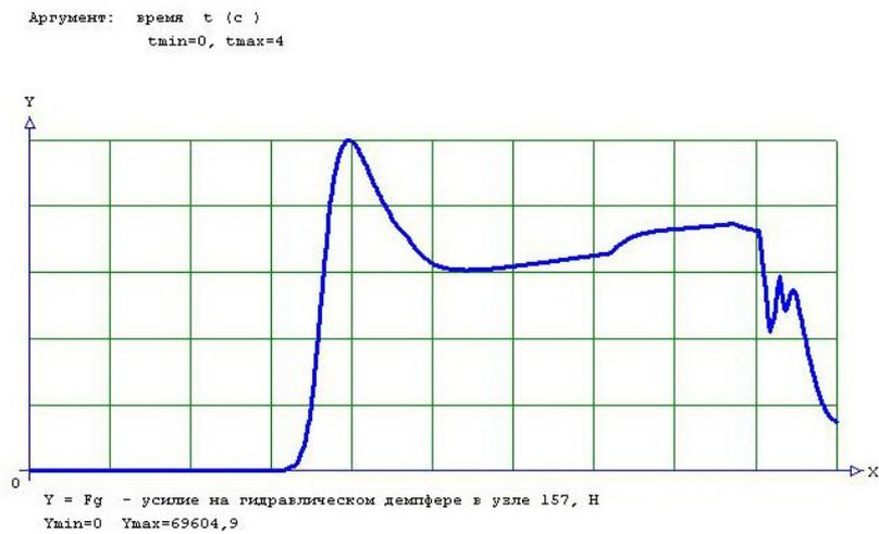
Рис. 5. График усилия в гидравлическом буфере
