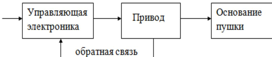
Рис. 1. Общая схема привода
