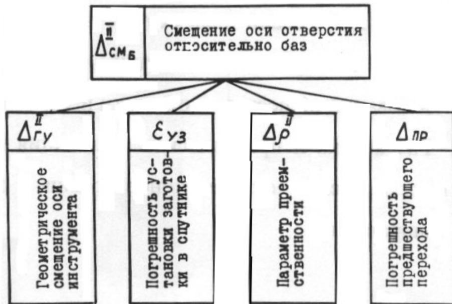
Рис.4. Схема образования погрешности смещения оси отверстий относительно баз (кондукторная плита, тип II).
