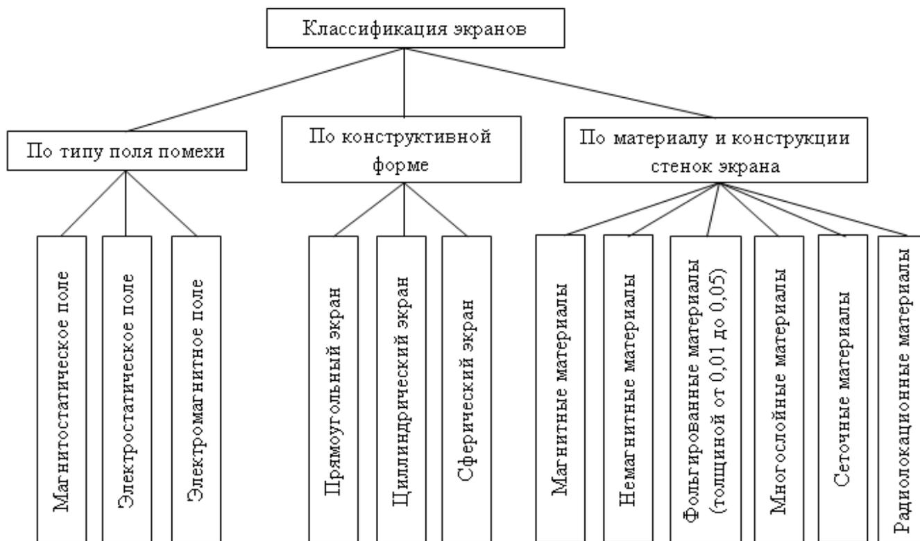
Рис.1. Классификация электромагнитных экранов
