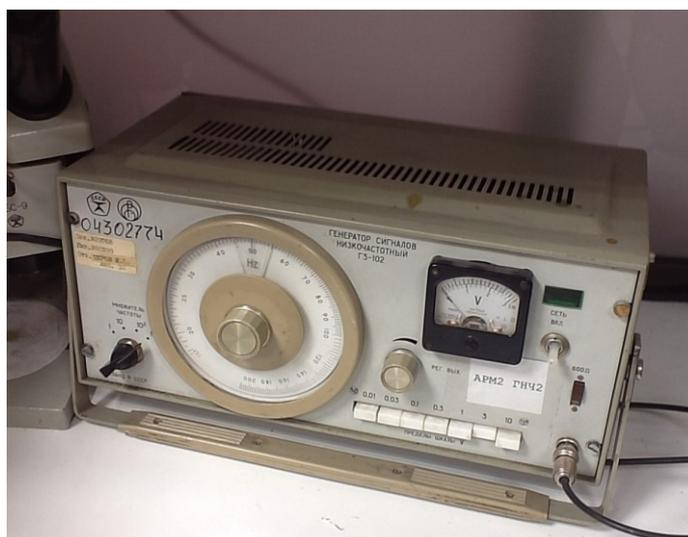
Рис. 3. Общий вид генератора ГЗ-102
