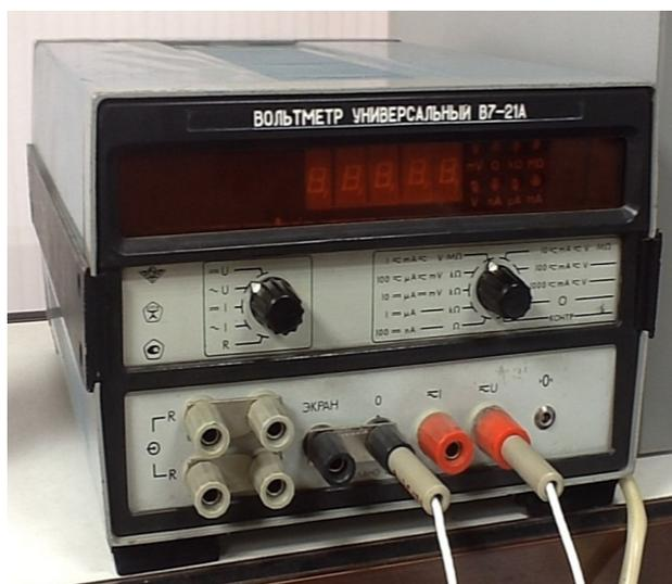
Рис. 4. Общий вид универсального вольтметра В7-21А
