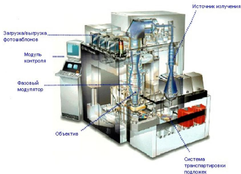
Рис. 4. Проекционная литографическая установка PAS5500/250C
