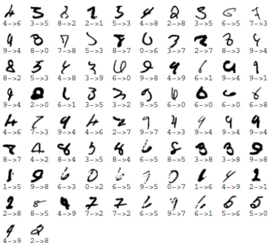
Рис.5. Примеры образов, неправильно распознанных программой: под каждой цифрой слева представлен правильный ответ, справа — ответ, выданный нейросетью
