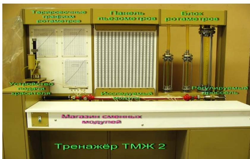
Рис. 1. Общий вид гидравлического стенда ТМЖ 2
