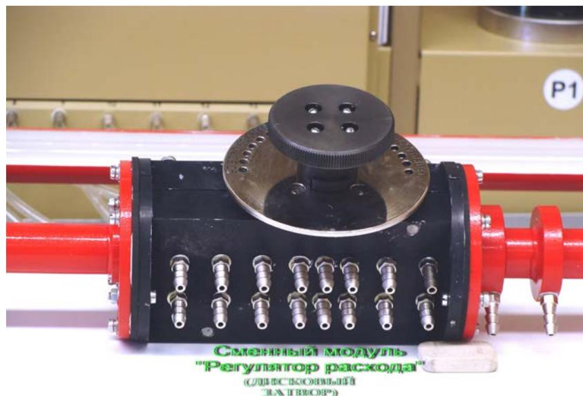
Рис. 13. Сменный модуль № 7 «Дисковый затвор» (точки отбора давления)
