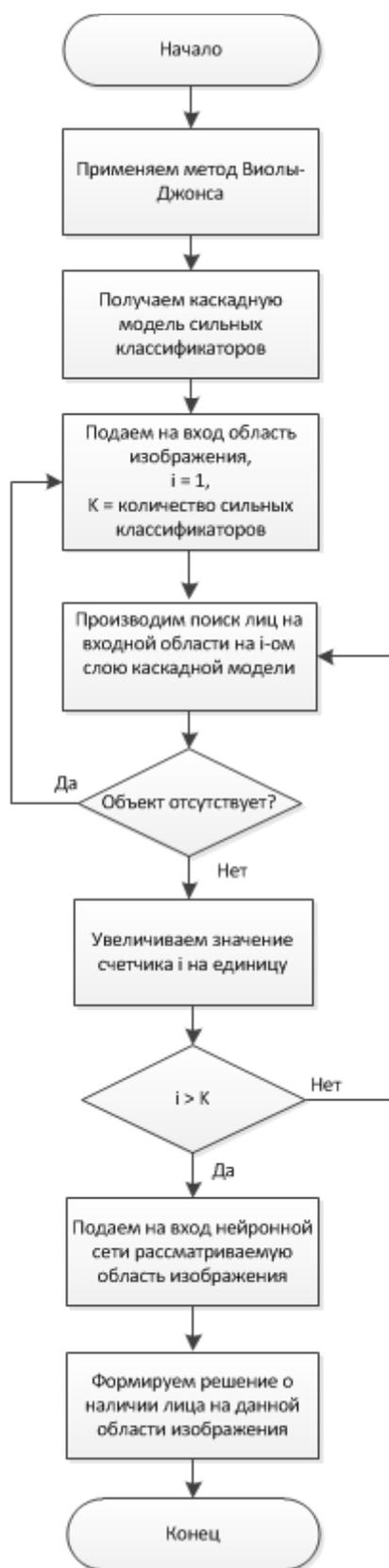
Рис. 1. Функциональная схема комбинированного метода обнаружения лиц
