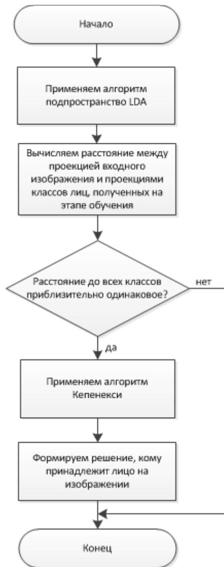
Рис. 4. Функциональная схема комбинированного метода распознавания лиц
