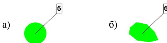
Рис. 6. Форма частиц абразива до (а) и после (б) взаимодействия со струей
