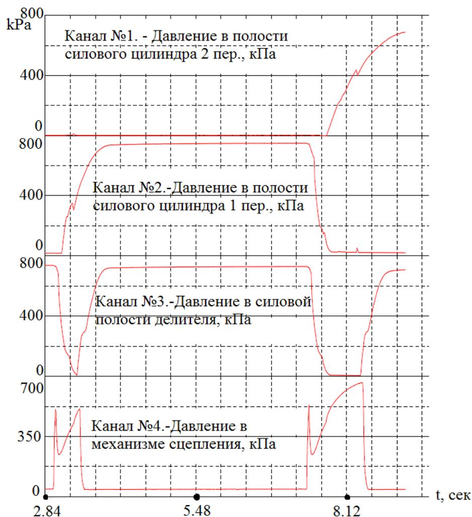
Рисунок 9. – Экспериментальное исследование работы электропневматического привода
