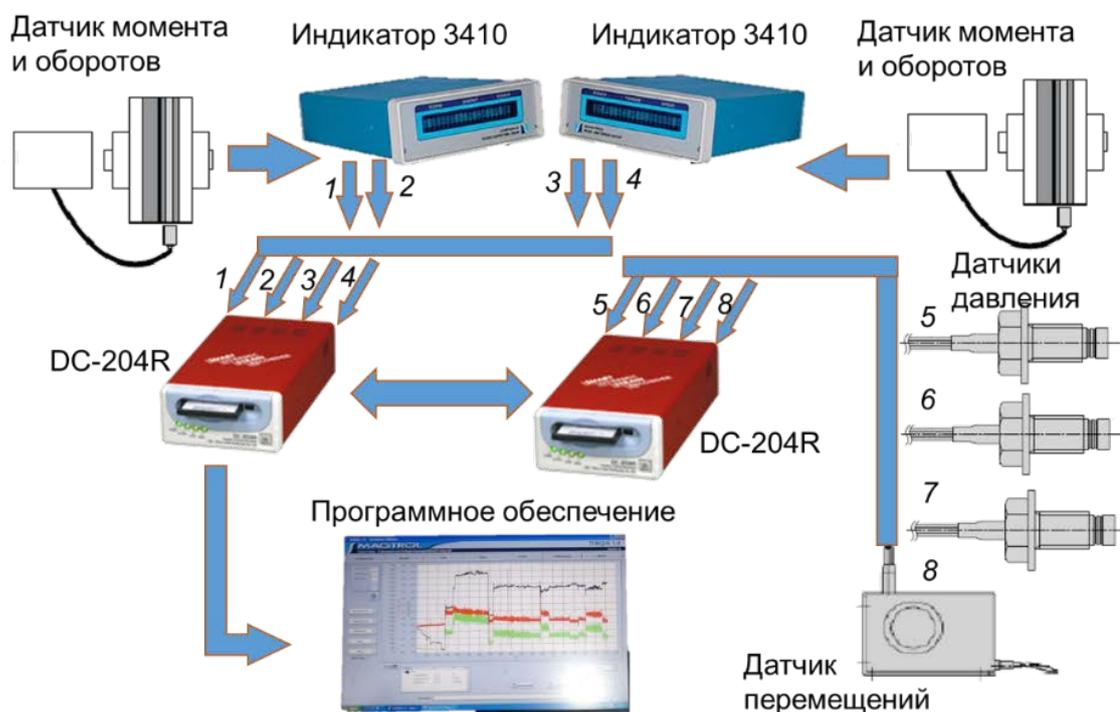
Рисунок 8. – Схема подсоединения измерительной аппаратуры стенда
