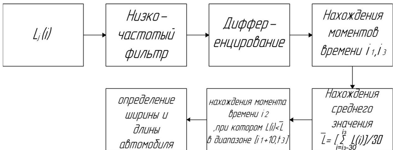
Рис. 13. Схема алгоритма обработки сигнала при проведении моделирования
