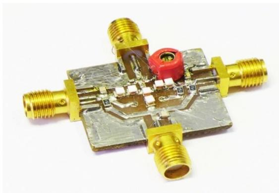
Рис. 6. Изготовленный пассивный разветвитель
