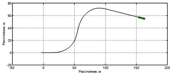
**Рис. 17.** Траектория движения МКМ (переставка на опорном основании «сухой лед»)
