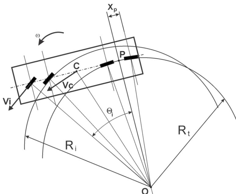
Рис. 2. Расчетная схема поворота транспортного средства.
