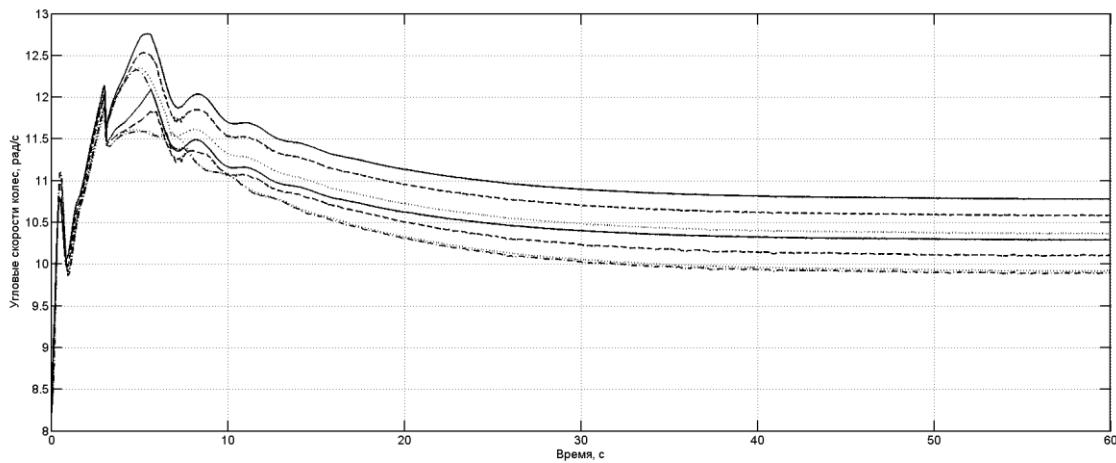
**Рис. 8.** Угловые скорости колес (поворот на опорном основании «сухой лед»)
