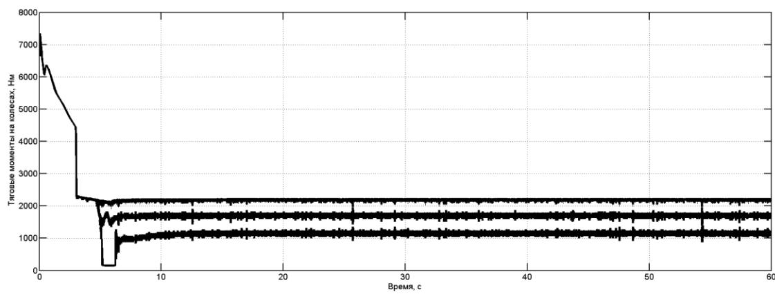
**Рис. 6.** Крутящие моменты на колесах (поворот на опорном основании «грунт»)
