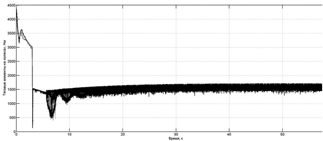
**Рис. 9.** Крутящие моменты на колесах (поворот на опорном основании «сухой лед»)
