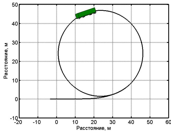
**Рис. 7.** Траектория движения МКМ (поворот на опорном основании «грунт»)
