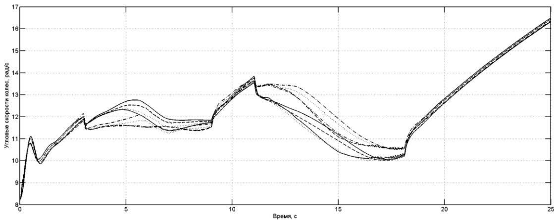
**Рис. 16.** Угловые скорости колес (переставка на опорном основании «сухой лед»)
