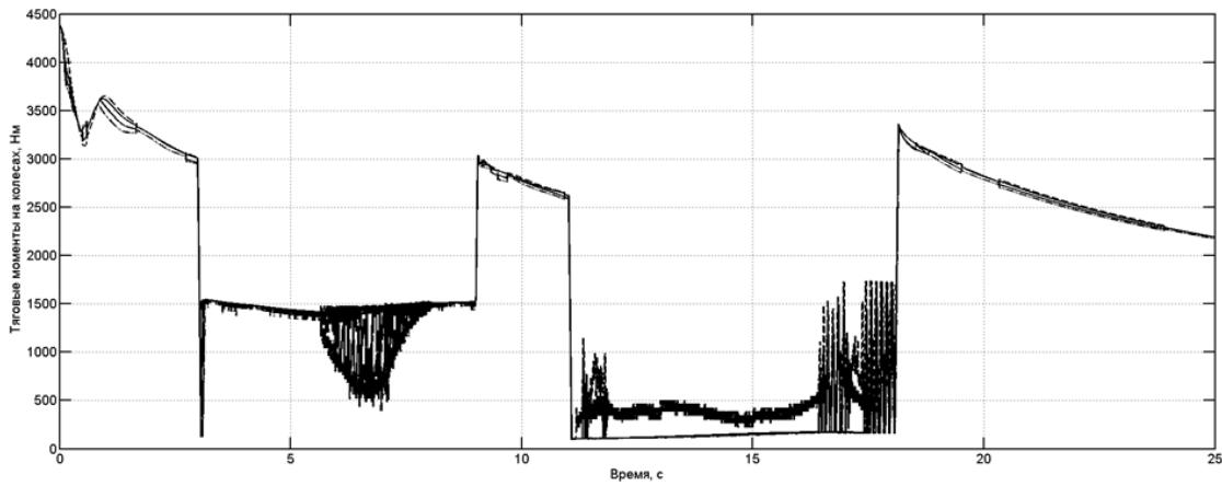
**Рис. 15.** Крутящие моменты на колесах (переставка на опорном основании «сухой лед»)
