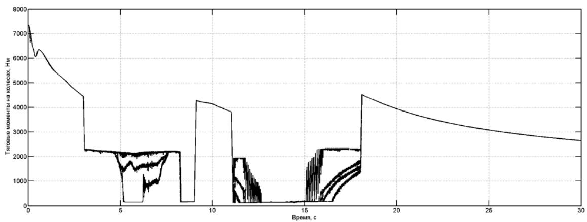
**Рис. 12.**Крутящие моменты на колесах (переставка на опорном основании «грунт»)
