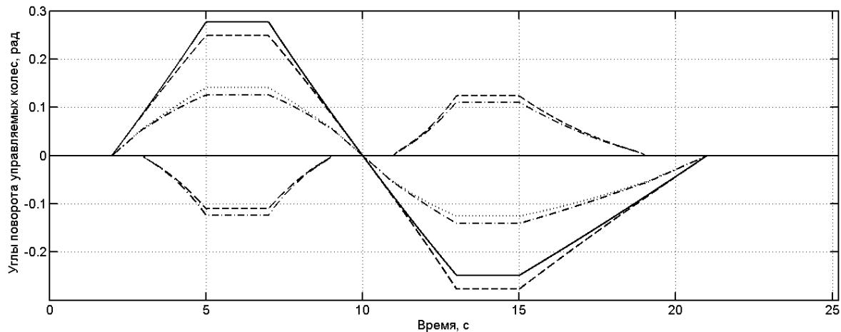
**Рис. 11.** Углы поворота колес при переставке Результаты моделирования представлены на рис. 12 – 17.
