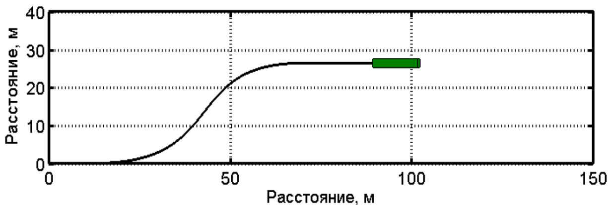
**Рис. 14.**Траектория движения МКМ (переставка на опорном основании «грунт»)
