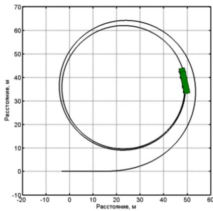
**Рис. 10.** Траектория движения МКМ (поворот на опорном основании «сухой лед»)
