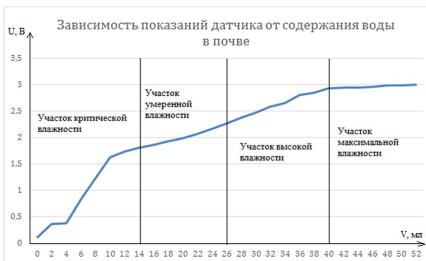
Рис. 5. График зависимости показаний датчика влажности от количества воды в почве
