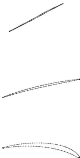
Рис. 2. Сплайн-линии сечений профиля пера лопатки (показано только 3 сечения)
