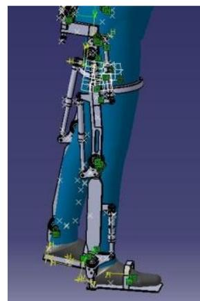
Рис. 17. Конфигурация ИМ, соответствующая extension бедра  $11^\circ$
