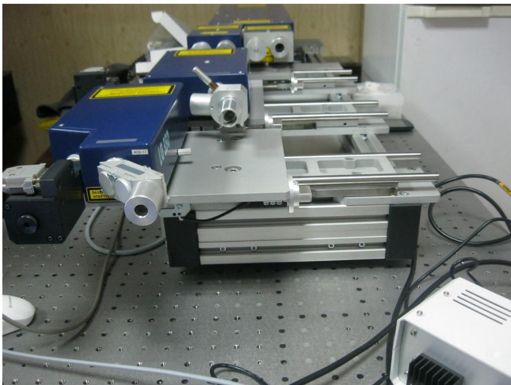
Рис. 3. Nd:YAG-лазер, используемый для эксперимента по абляции
