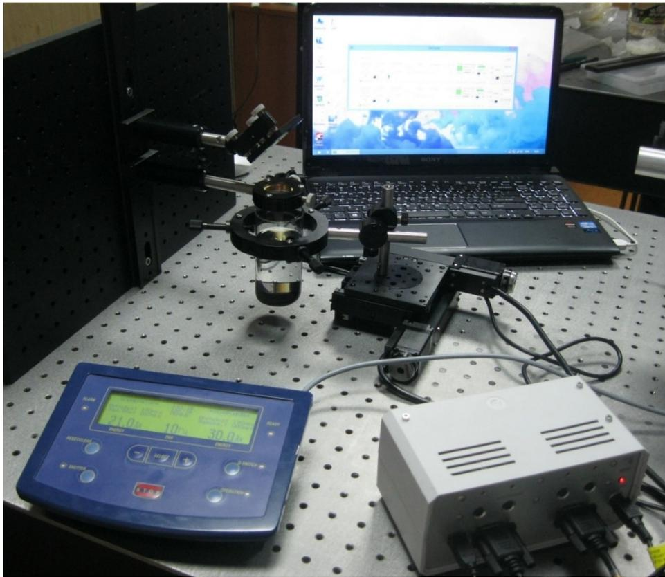
Рис. 1. Установка для абляции металлической мишени в жидкости
