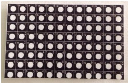
Рис. 4. Бумажный планшет с гидрофобным покрытием: на области бумаги, окрашенные в черный цвет, наносится парафин
