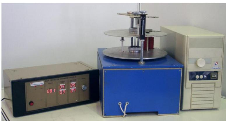
Рис. 5. Экспериментальная установка для исследования эффективности виброзащитных устройств ТММ 98-8
