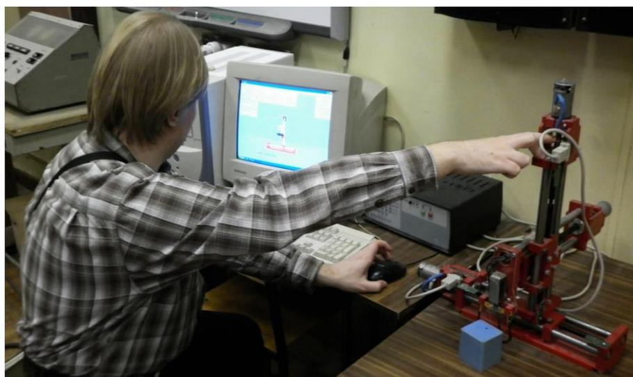
Рис. 7. Робототехнический комплекс на базе модульного манипулятора УМР-3-0
