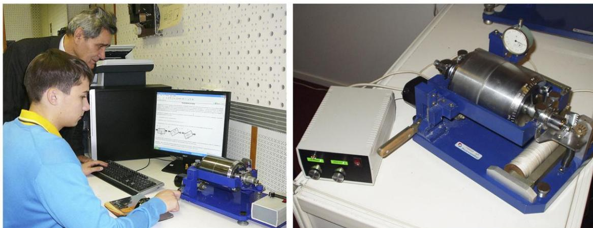
**Рис. 3.** Установка для динамической балансировки роторов и лабораторная работа, выполняемая на ней
