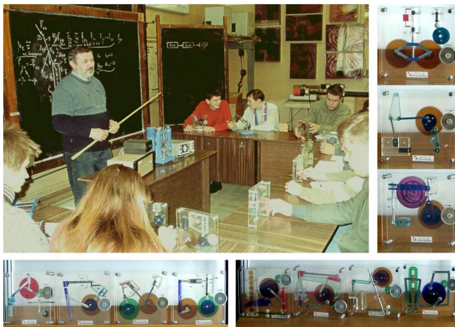
**Рис. 1.** Комплект моделей механизмов машин и лабораторная работа по структуре механизмов
