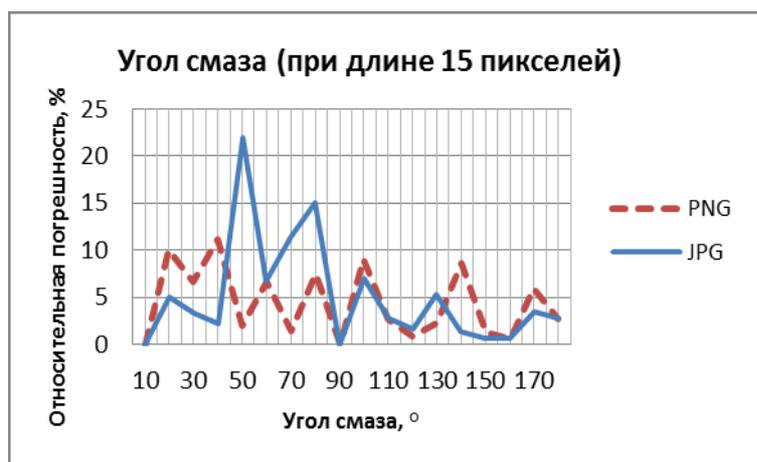
График 1. Определение угла смаза
