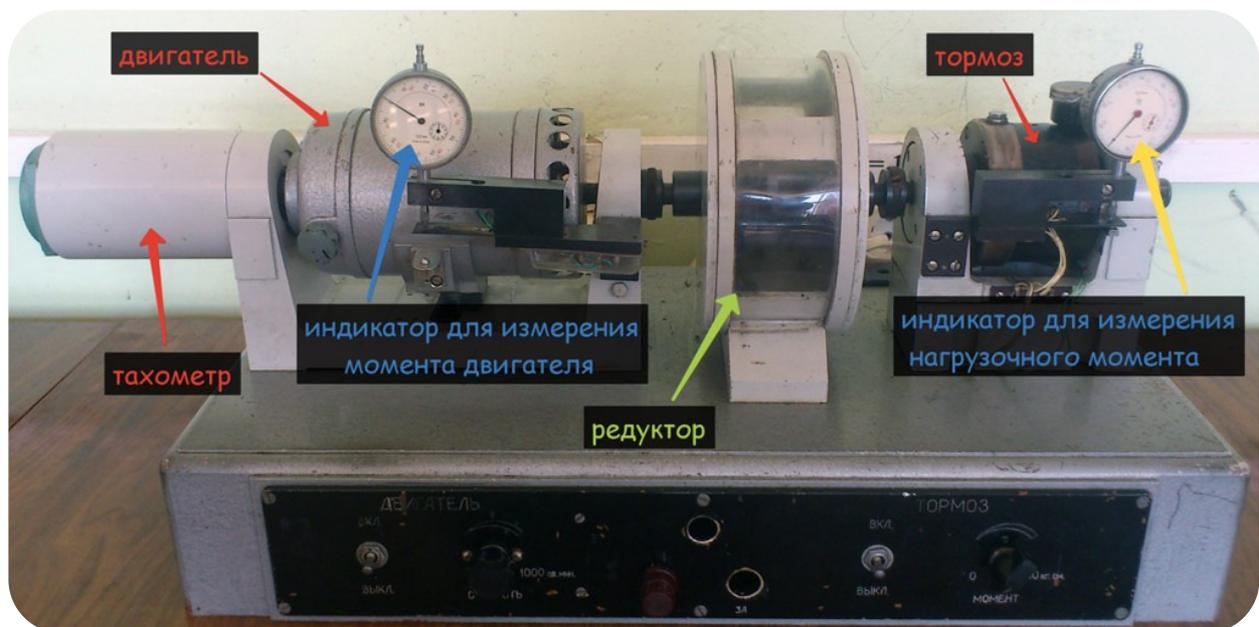
Рис. 2. Лабораторная установка с планетарным редуктором
