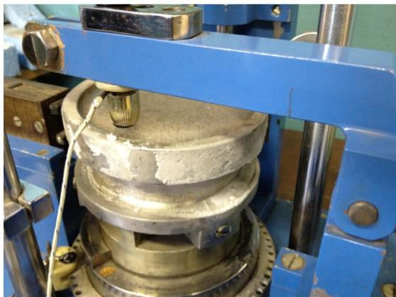
Рис. 1. Установка УТУ-3 с установленным образцом ледяной поверхности
