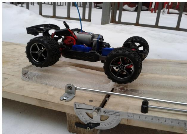
Рис. 19. Исследование взаимодействия модели колесной машины и льда на стенде Горка-2 (с «мягкими» колесами)
