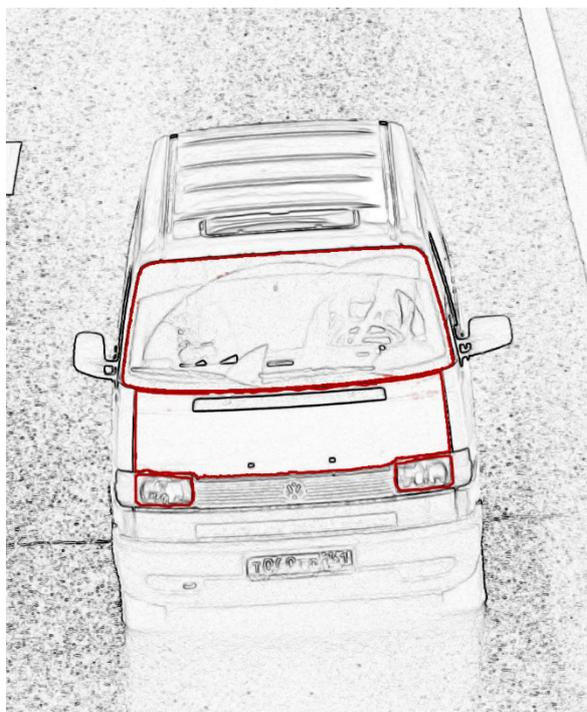
Рис. 3. Выделенные характерные детали автомобиля
