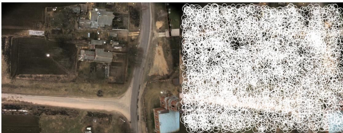
Рис. 2. Слева - пример фотографии, полученной при АФС, справа - результат работы на данной фотографии детектора SURF
