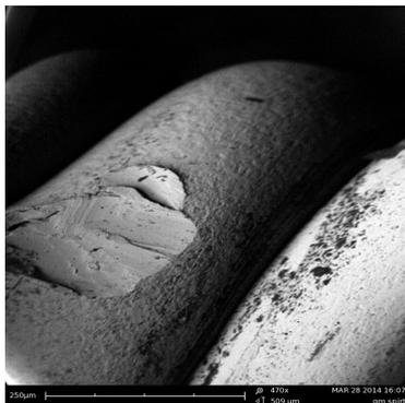
Рис. 5. Изображение поверхности струны Господин музыкант «Бронзовый век», полученное при помощи РЭМ
