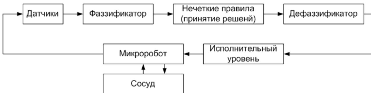
**Рис.8.**Схема нечеткого контура управления контактным элементом
