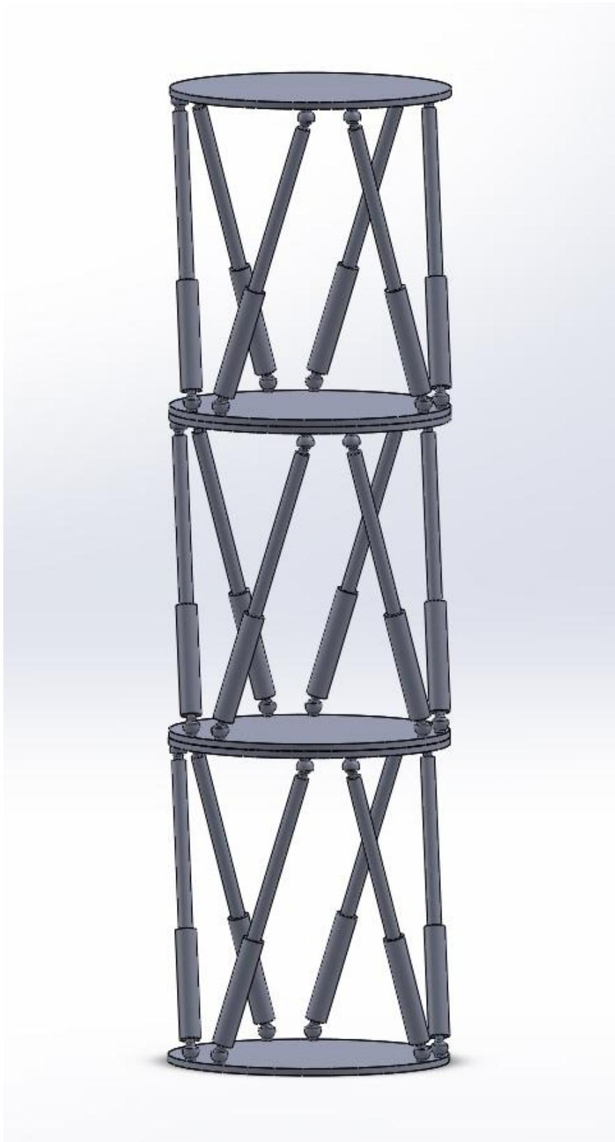
**Рис. 3.** 3D-прототип многосекционного манипулятора параллельной кинематики
