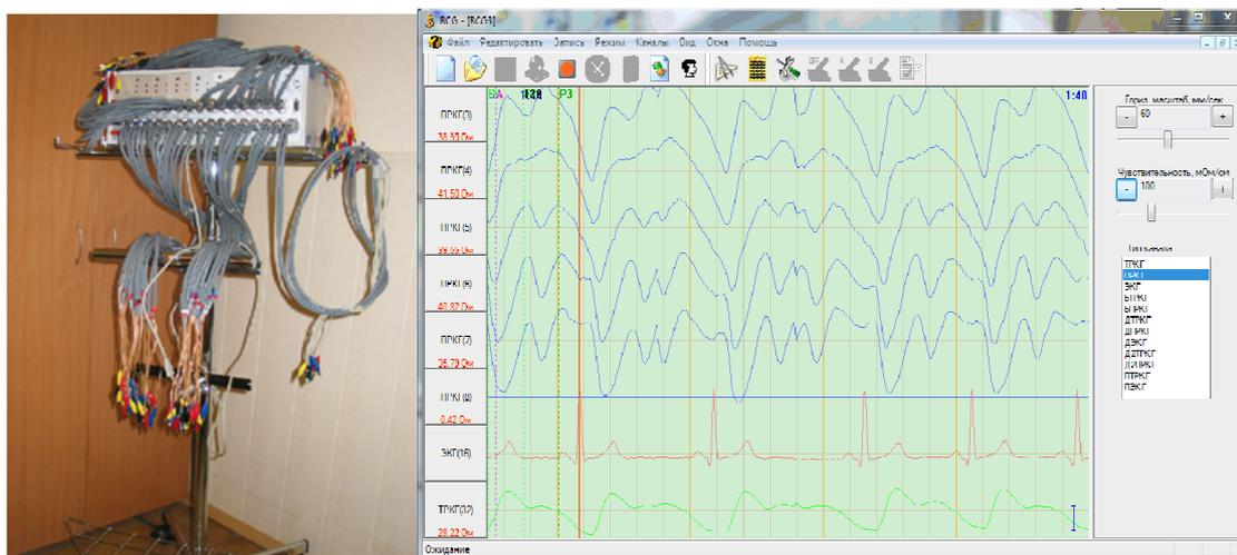
Рис. 1. Многоканальная система для импедансного картирования «РЕО-32» и программное обеспечение
