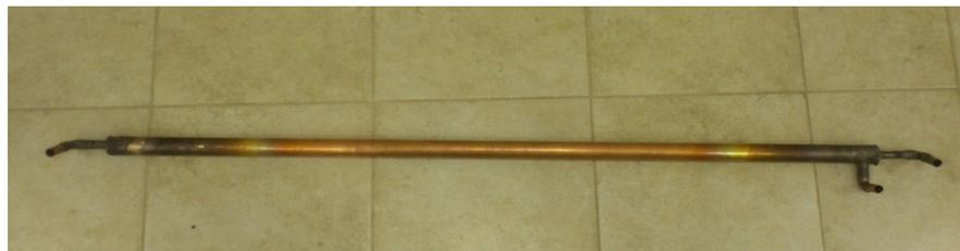
Рис. 6. Модельный теплообменный аппарат типа «труба в трубе»
