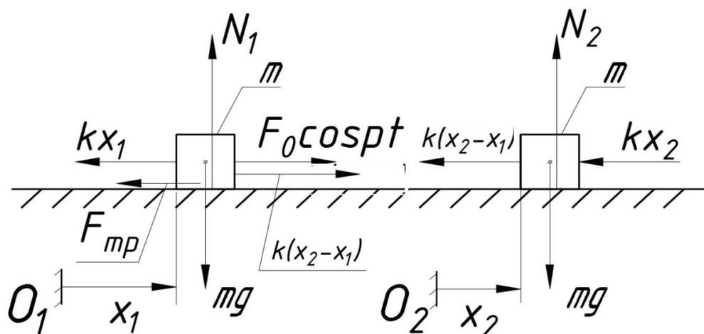
Рис. 2. Силы, действующие на рассматриваемую колебательную систему
