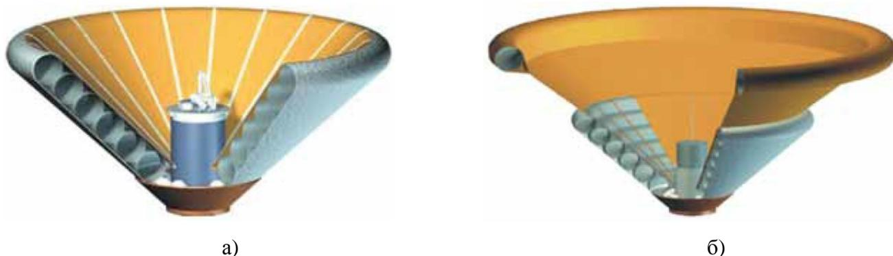
Рис. 2. Спускаемый аппарат с двухкаскадным надувным тормозным устройством:
