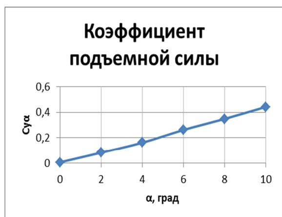
Рис. 5. График зависимости коэффициента подъемной силы от угла атаки
