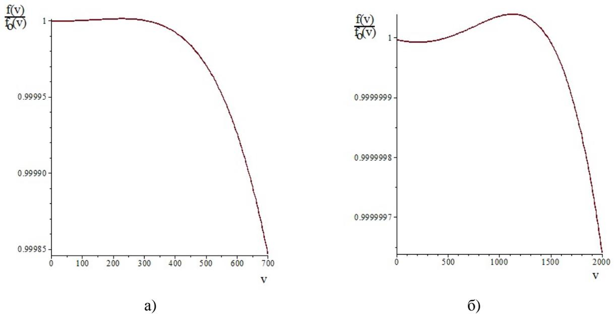
Рис. 2. Отношение полученной функции распределения к нормальной а) для атома Au массой 196 а. е.; б) для атома F массой 19 а. е.
