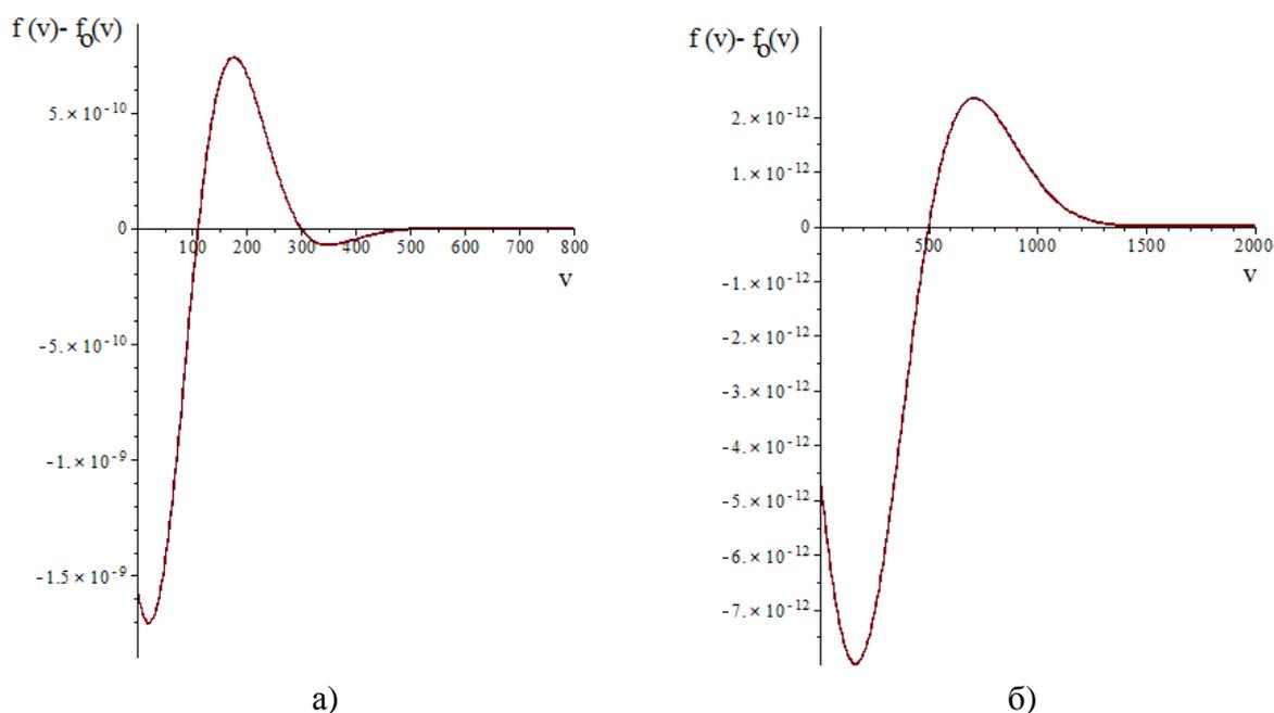
Рис. 1. Разница между полученной функцией распределения и нормальной а) для атома Au массой 196 а. е.; б) для атома F массой 19 а. е.
