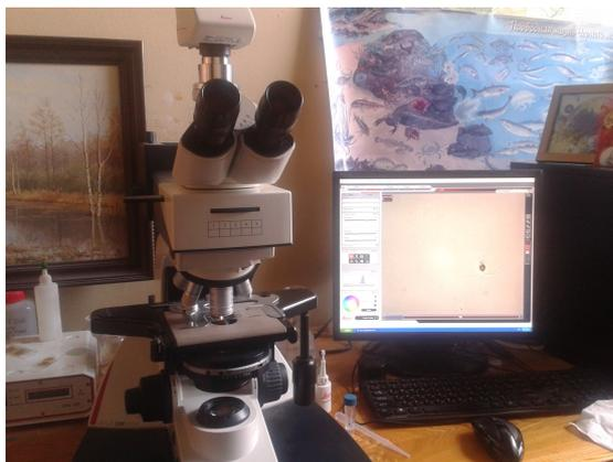
Рис. 7. Микроскоп Leica с выведенным на монитор полем зрения окуляра
