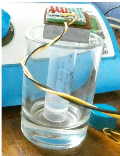
Рис. 6. Макетная плата с УФ излучателем
