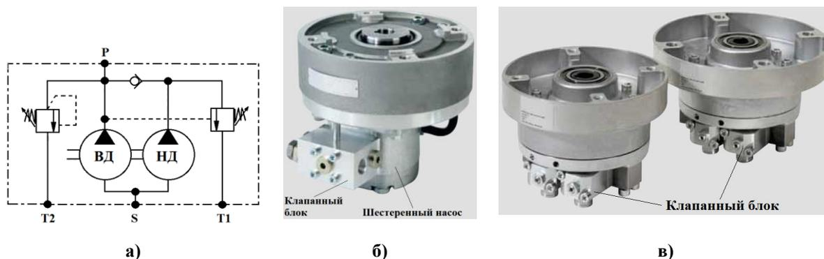
**Рис. 9.** Гидросхема комбинированного насоса и внешний вид его исполнений
