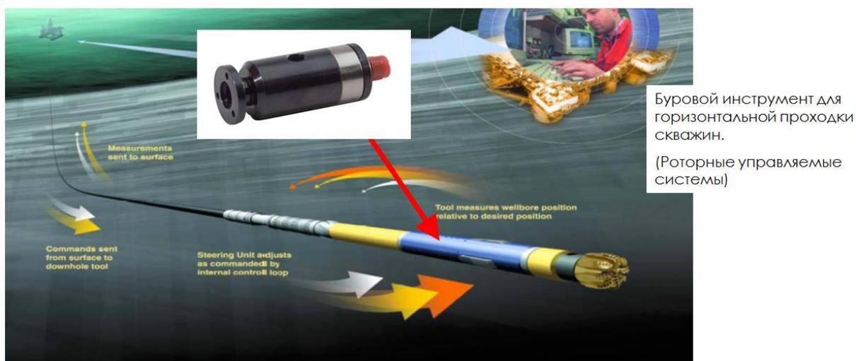
Рис. 5. Микронасос сверхвысокого давления в буровом инструменте
