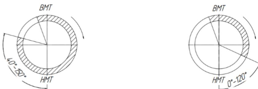
Рис. 2. Фазовые диаграммы впускного клапана: а) цикл Аткинсона;
