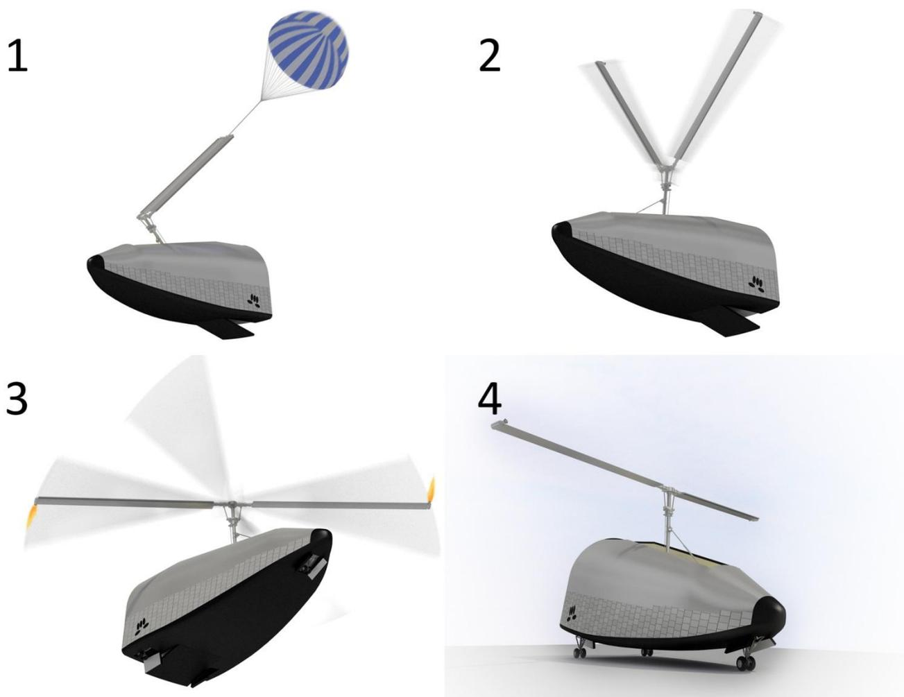
Рис.2.2. Пример роторной системы посадки СА класса «несущий корпус».
