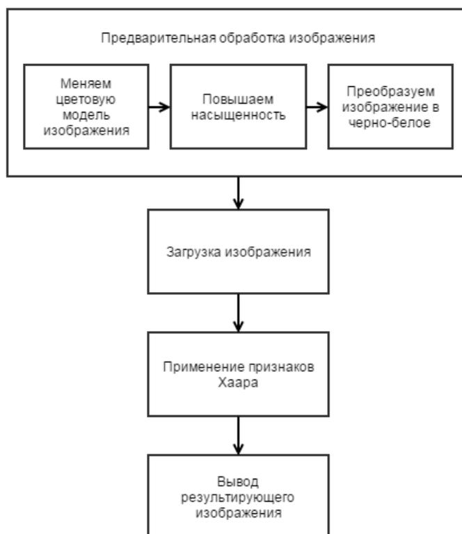
Рис. 4. Блок-схема алгоритма программы
