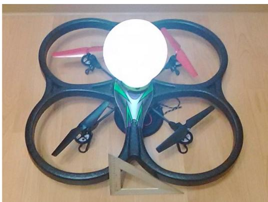
Рис. 3. Внешний вид БПЛА с бортовым навигационным огнем
