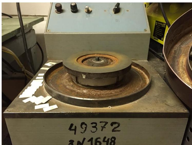
Рис. 4. Доводочно-полировальный станок эксцентрикового типа К3827
