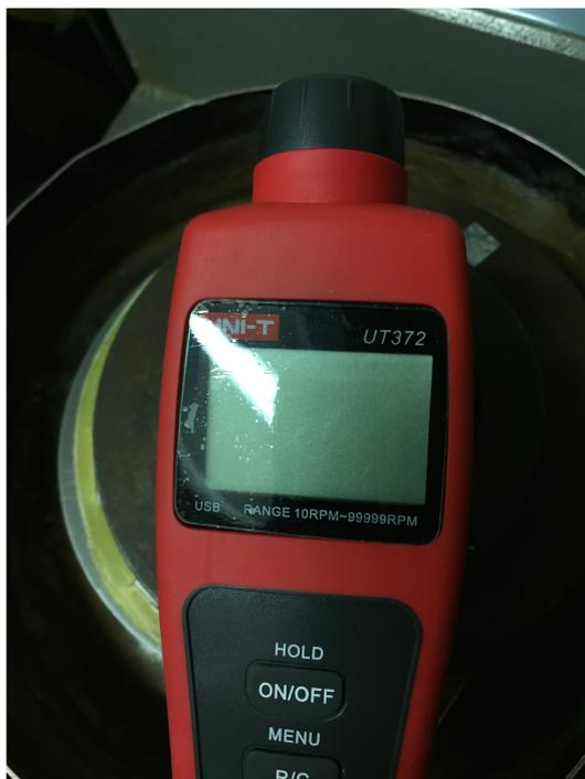
Рис. 6. Лазерный тахометр UT372
