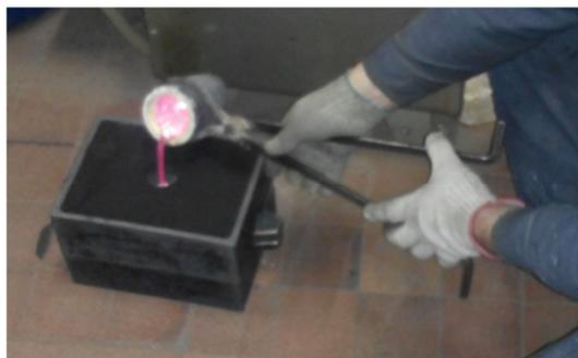
Рис. 7. Заливка в формы
