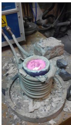
Рис. 6. Плавка металла АК12 в печи
